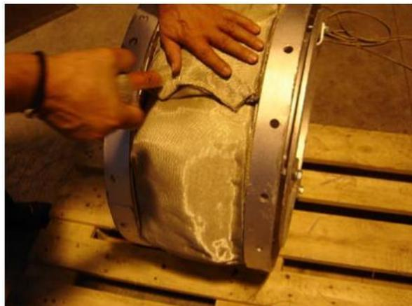
3. Colocar la banda alrededor de la superficie de la junta presentando las contrabridas de sujeción y dejando la zona de empalme libre.
