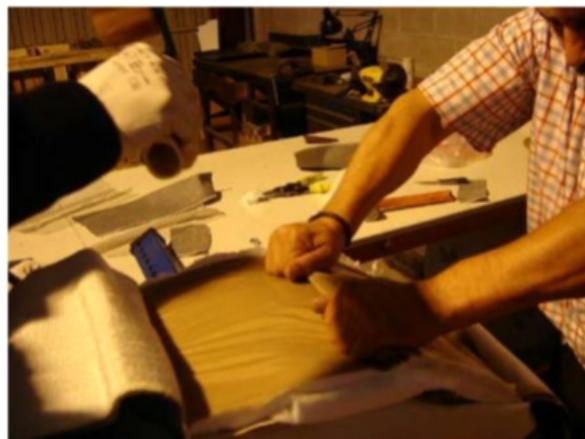
6. Empalme de la capa externa. Pegar con silicona de alta temperatura (suministrada por Montero fye) siguiendo las instrucciones del fabricante del adhesivo.
