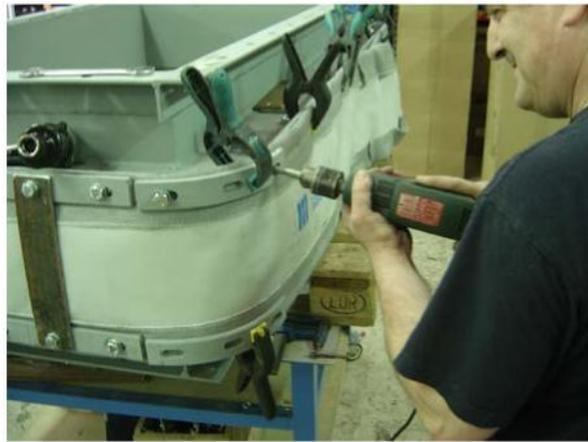
4. Solapar las distintas capas aislantes posicionando alternativamente los solapes de cada una de las capas a izquierda y derecha.
